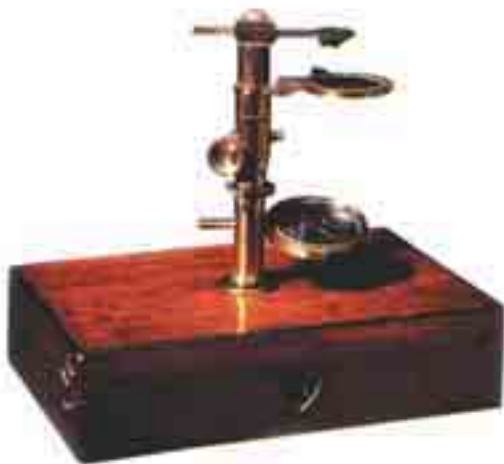
Das einlinsige Mikroskop, das Darwin benutzte, zeigt die begrenzten technischen Möglichkeiten jener Zeit.
