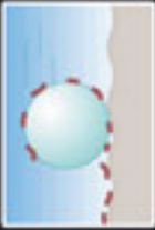
Yağmur damlasının lotus yaprağı üzerindeki temizleyici etkisi
